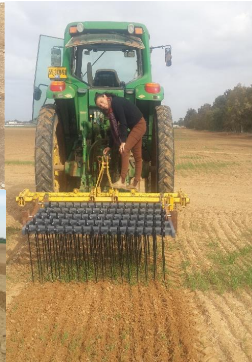
משמאל למעלה בכיוון השעון: קולטיבטור קל, משדדת סיכות ניסיונית של "צח עפולה", משלבה בשטח הניסוי באורים
